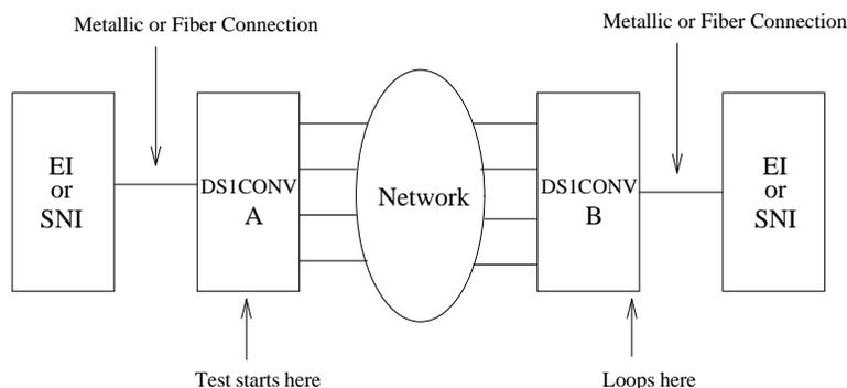
**Figure 9-25. Far-end DS1 CONV Loopback Test (#788)**
