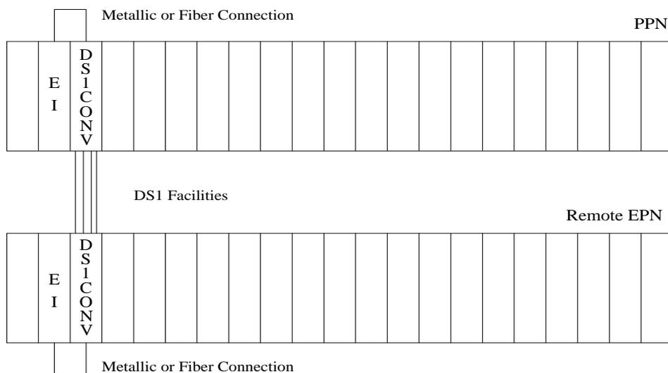
Figure 9-23. DS1 CONV Complex in Direct Connect PNC
