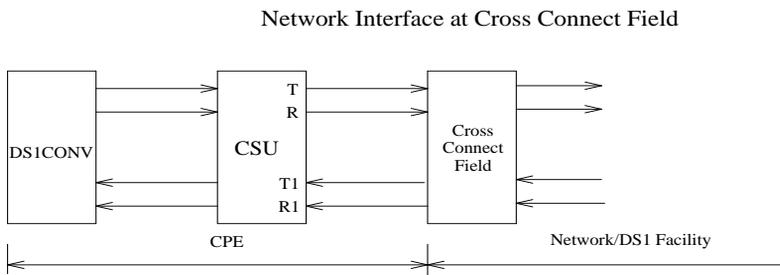
Figure 9-18. DS1 Facility Connections
