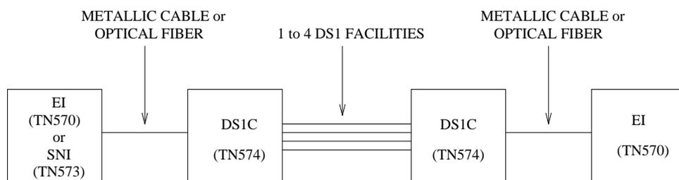
**Figure 9-31. Fiber Link with DS1 Converter Complex**
